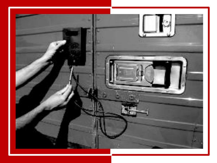
eLOCK GOLD es un avanzado cierre de seguridad reutilizable, que controla la posición y el estado del camión o del contenedor, a través del uso de tecnologia GPS y comunicación GSM/GPRS, usando tanto dispositivos fijos que móviles (smartphones y tablet).
